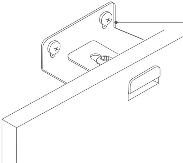
4 Platinas de fixation (2 en haut et 2 en bas) en acier thermolaqué ép. 1.5 mm. Fixation par vis (fournies)
