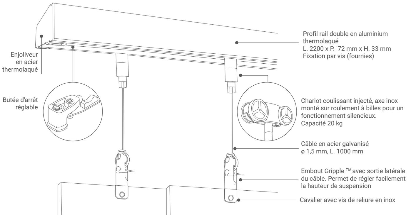
Le profil rail double L 2200 mm permet le coulisement de 2 panneaux l'un derrière l'autre. Il est fourni avec 2 enjoliveurs et 4 butées d'arrêt réglables et amovibles.
